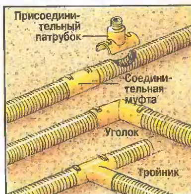
Рис. 2. Фитинги облегчают сборку дренажной системы
