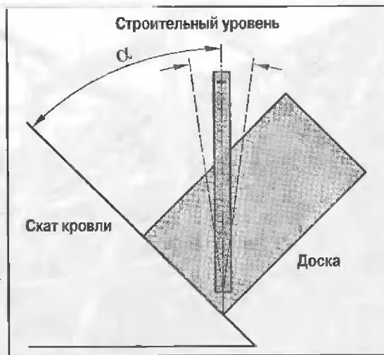
Рис. 3. Шаблон для изготовления элементов каркаса
